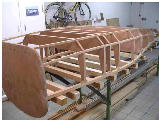
Vu ses petites dimensions, il est possible de construire cette machine dans un local type garage à voiture (5,5m x 3m) : le fuselage fait 4,25m, les longerons d'ailes font 3,60m ou 4m pour l'ULM. Monter le fuselage au plafond pour construire les ailes.
